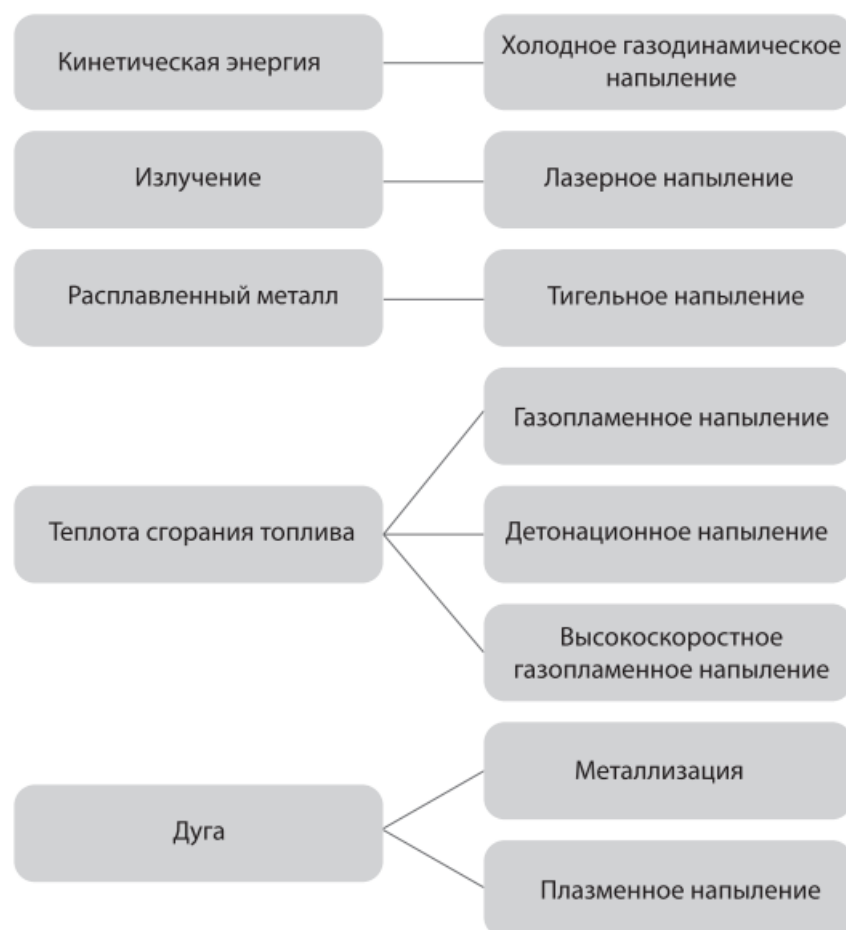
Рисунок 1.10 – Классификация способов нанесения защитных покрытий по источнику энергии для воздействия на распыляемый материал
