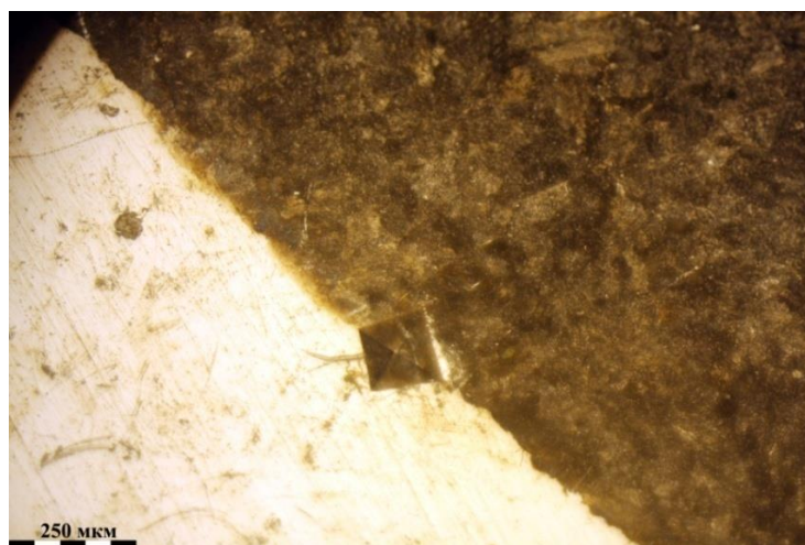
Рисунок 5.11 - Размер отпечатка на шлифе образца
